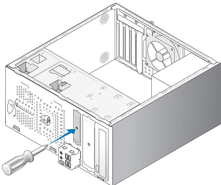
Ευθυγραμμίστε το άκρο ενός κατσαβιδιού Phillips με την υποδοχή στο μεταλλικό έλασμα αποσύνδεσης και περιστρέψτε προς τα έξω το κατσαβίδι για να σπάσετε και να αφαιρέσετε το μεταλλικό έλασμα.
